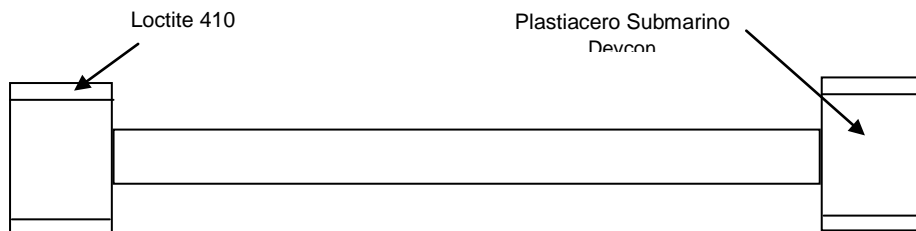
Figura 8 - Instalación usando Adhesivo Epoxídico
