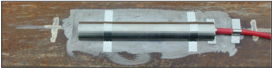
FIGURA 18: Placa de protección colocada con soldadura por puntos
