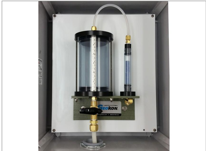
**FIGURA 4:** Depósito de líquido y cámara desecante conectadas con un puente
