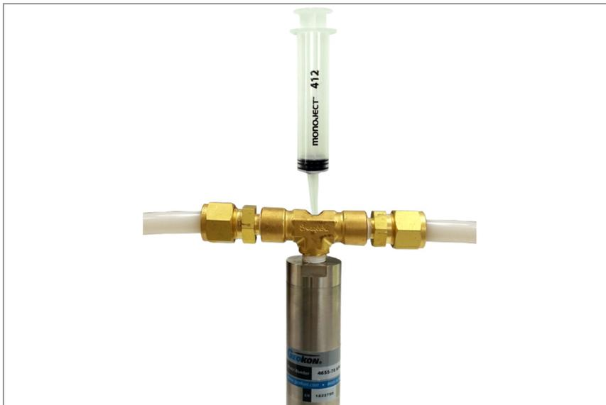
**FIGURA 7:** Uso de la jeringa para la extracción de aire o líquido
