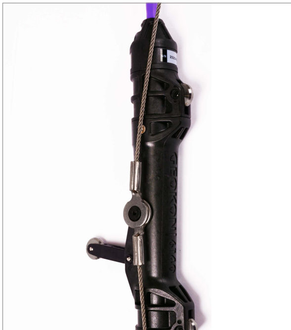
FIGURA 11: Coloque el ojal de la siguiente sección de la cadena sobre el ojal existente
