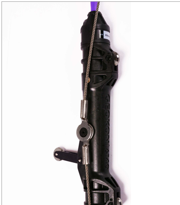
ILLUSTRATION 11: Disposez l'œillet de la section de chaîne suivante sur l'œillet existant
