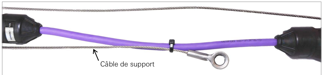
ILLUSTRATION 42: Fixez le câble de support à la chaîne
