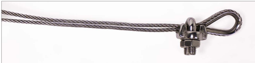
ILLUSTRATION 54: Insérez et serrez la cosse dans la boucle
