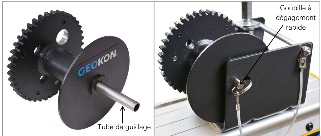
ILLUSTRATION 47: Installez un enrouleur vide avec la goupille à dégagement rapide
