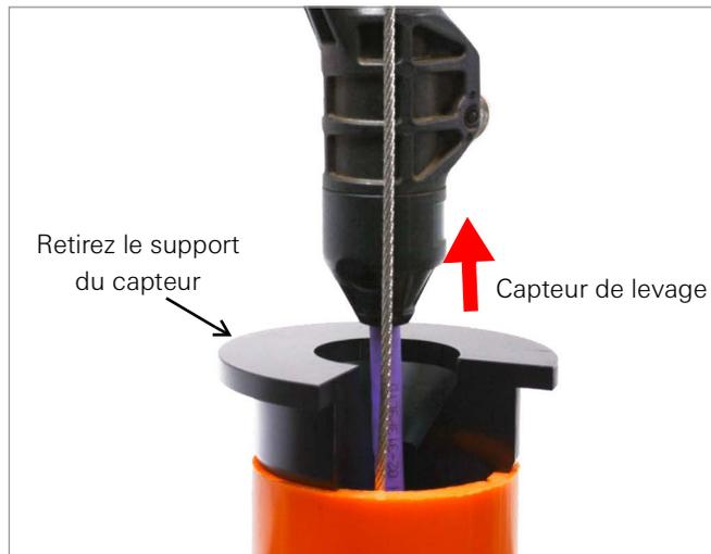
**ILLUSTRATION 40:** Capteur soulevé du support de capteur
