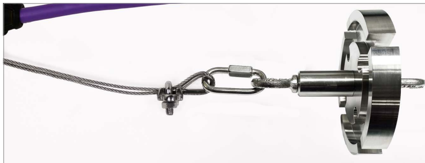
FIGURA 55: Cabo de suspensão ajustado com suporte
