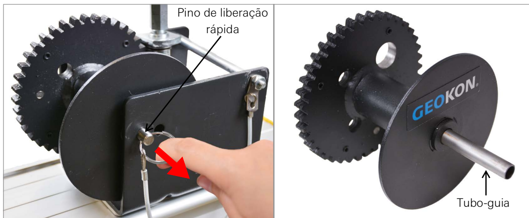
FIGURA 43: Remova a bobina vazia e o tubo-guia
