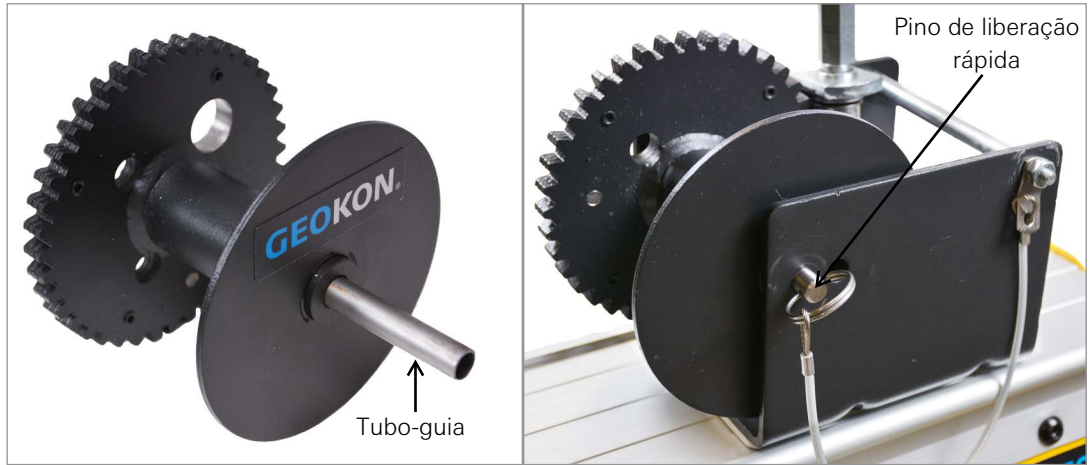
FIGURA 47: Instale uma bobina vazia com o pino de liberação rápida
