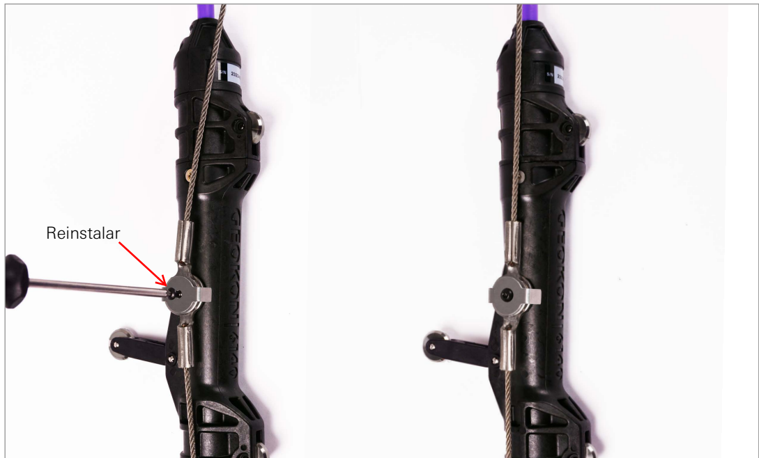
FIGURA 12: Fixação dos ilhós dos cabos de segurança, conexão dos cabos de segurança concluída
