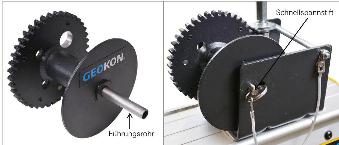
ABBILDUNG 47: Eine leere Trommel mit dem Schnellspannstift installieren
