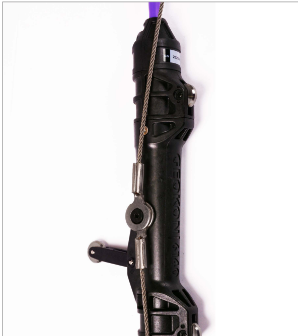
ABBILDUNG 11: Öse aus dem nächsten Strangabschnitt über der vorhandenen Öse anordnen
