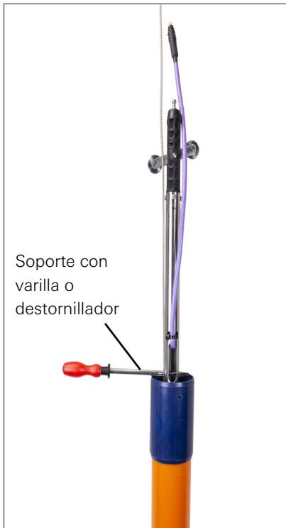
**FIGURA 7:** Soporte sensor con varilla
