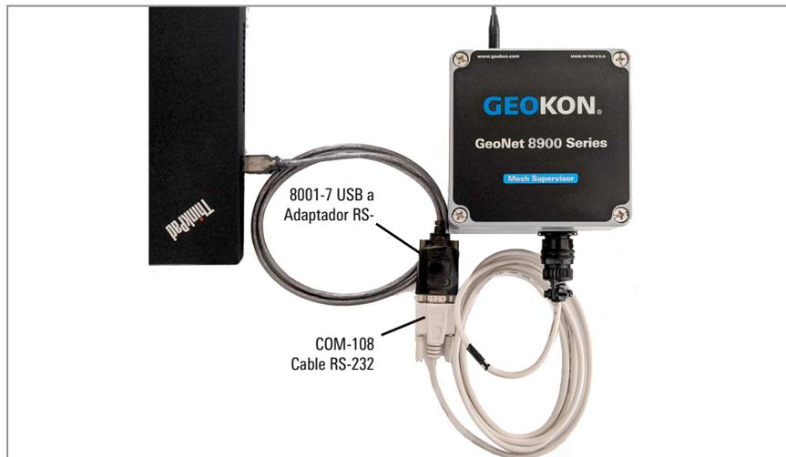
**FIGURA 35:** Conexión del cable RS-232
