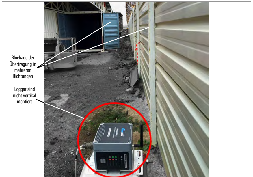
ABBILDUNG 18: Montage nahe bei Gebäuden oder Zäunen/Mauern und/oder in horizontaler Ausrichtung
