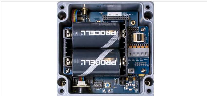
**FIGURA 16:** Detalle de la batería
