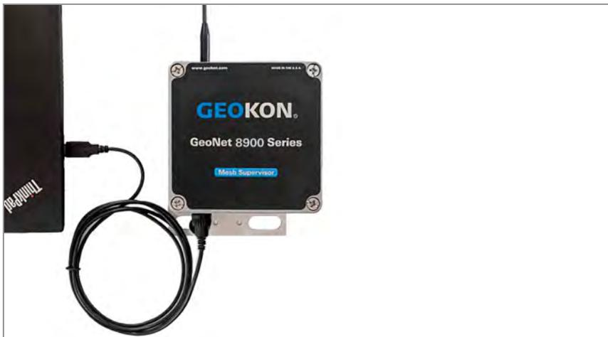
**FIGURA 35:** Conexión del cable USB
