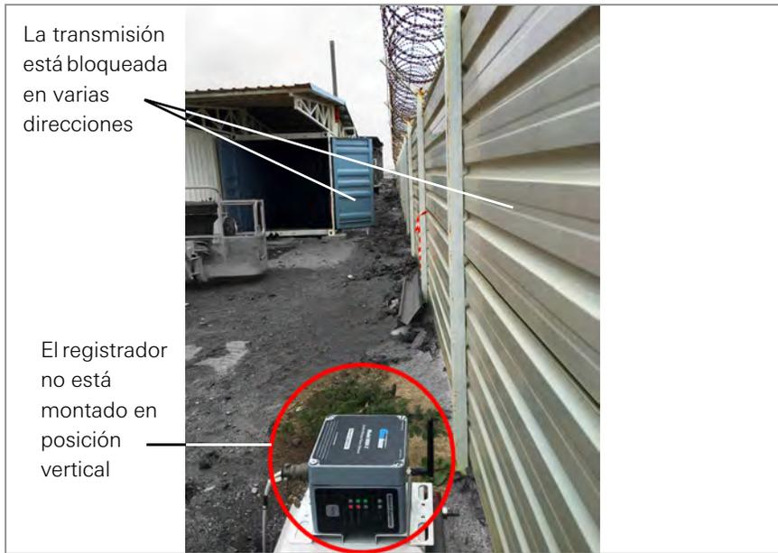
**FIGURA 18:** *Instalación cerca de edificios o vallas/paredes y/o en posición horizontal*
