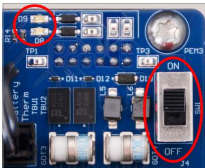
**FIGURA 1:** Localização do LED da bateria do gateway (esquerda) e interruptor (direita)
