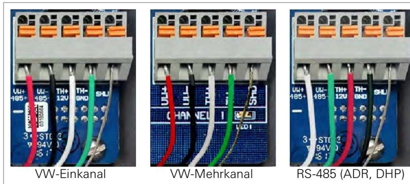
**ABBILDUNG 2:** Terminalverbindungen
