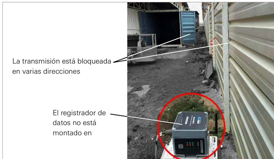
**FIGURA 15:** Instalación cerca de edificios o vallas/paredes y/o en posición horizontal
