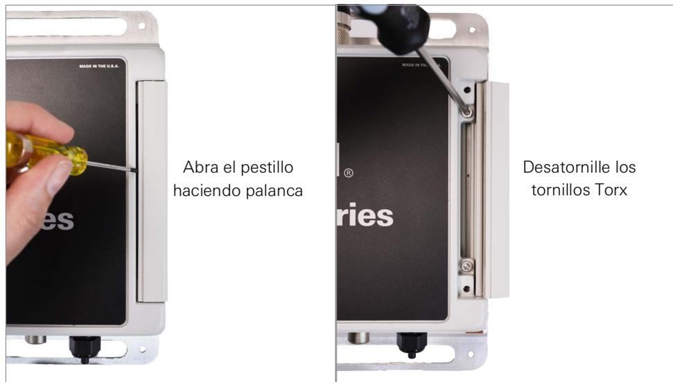
**FIGURA 10:** Abra la cubierta
