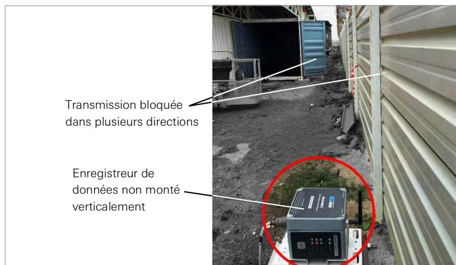
**ILLUSTRATION 15:** Installation à proximité de bâtiments ou de clôtures/murs et/ou horizontalement
